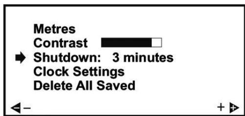
バッテリーを長持ちさせるため、本機はオートパワーオフ機能が搭載されています。シャットダウンの時間は無操作より 1 分・2 分・3 分から選択できます。設定変更には下方カーソル(▼)を押して ➡ でシャットダウン(Shutdown)に合わせます。
