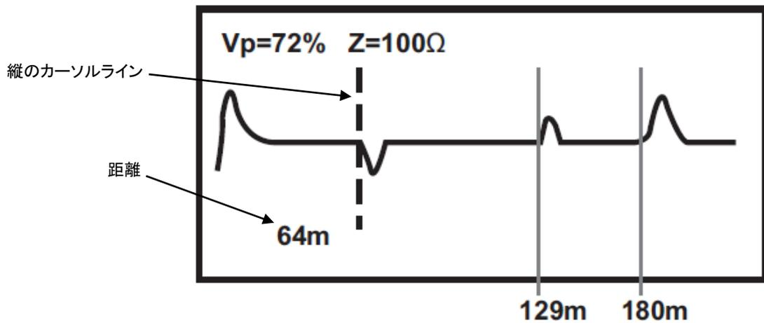
縦のカーソルラインは◀と▶キーで波形上を左右に移動することができ、事故点までの距離を測定します。イベントの始まる個所にカーソルを合わせて左下の距離の値を読み取ります。
