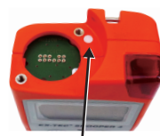
ポンプフィルター
