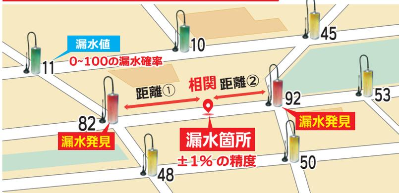
相関検査で漏水箇所をピンポイント検出
