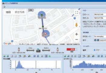
自動相関と人工知能による高精度の漏水箇所特定
