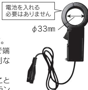
**ポイント:**情報: LANケーブルをご利用いただく時はクランプの内側に2、3回巻き付けると送信強度が上がり、電磁波の侵入しづらいLAN回線にもご利用いただけます。
