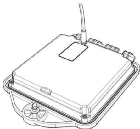
図 4.13 送信器のリチウムイオン電池パックの充電
