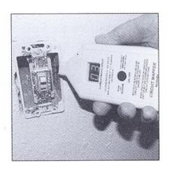
3. 接触探索が不可能な場合、内臓アンプによりほぼ全ての電力線の被覆上からの非接触探索が可能です。目的線の被覆上に受信機の角型受信部(写真左参照)を当てます。LED に識別番号が表示されるまで受信機の ON/OFF ボタンを長押しします。複数の数値表示がないことを確認するため、更に 2 秒間
