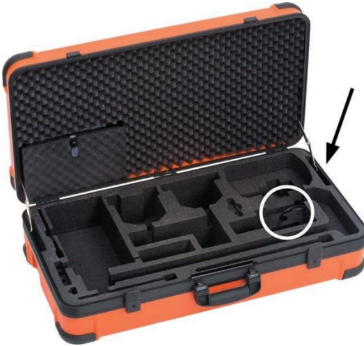
図 29: 3つの接続ケーブル（白丸） ケース外側の接続ソケット（黒矢印）
