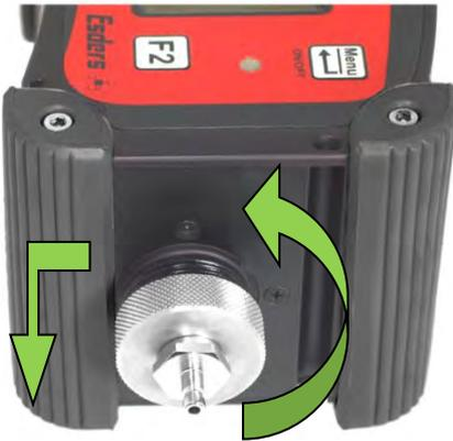
撥水フィルターを交換するには、本機側面の接続ヘッドのネジを外します。接続ヘッドを外すには、ローレットねじを左に回して本機から取り外します。
