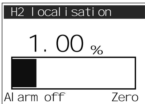
センサーの起動後、本機は現在の測定値を表示します。新鮮な空気中では、「0」と表示されます。(O<sub>2</sub> と CO<sub>2</sub> を除く)。必要に応じて、F2 キー (Zero) を使用してゼロ点をリセットできます。
