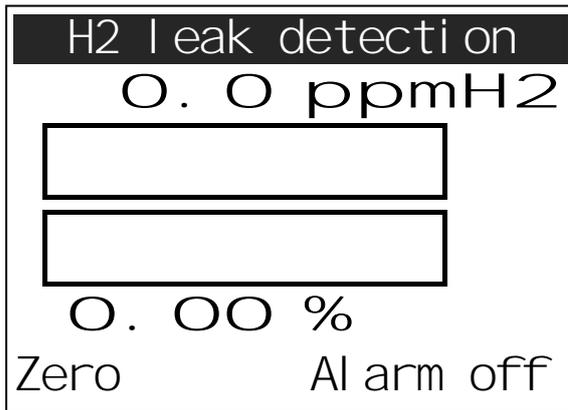
ガス濃度は、0 ~ 999 ppm の範囲で ppm 単位で表示されます。それを超えると、表示が +++ に変わり、測定範囲の 1,000 ppm を超えたことを示します。
