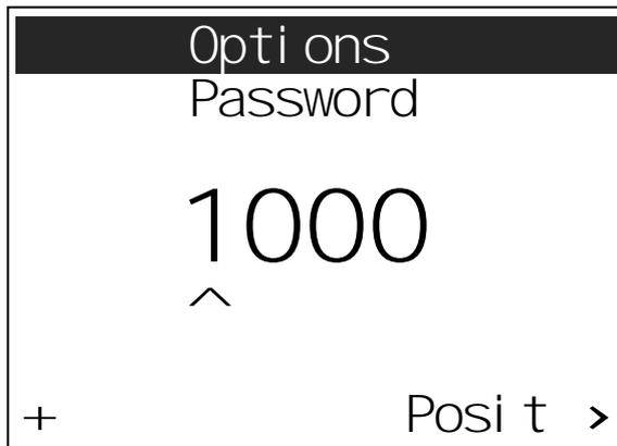
オプションメニューを使用すると、本機に対してさまざまな調整を行うことができます。これを行うには、ユーザーは最初にパスワードを入力する必要があります。F1 キー (+) を使用して選択した桁 (0-9) を増やし、F2 キー (Posit >) を使用して次の桁を選択します。「メニュー」キーを押すと、パスワードが確認されます。パスワードは「1000」にあらかじめ設定されており、特別なソフトウェアを使用して変更できます。
