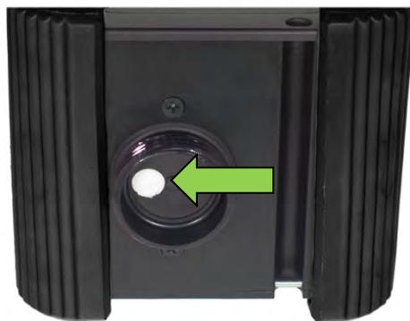
接続ヘッドのネジを外し、フィルターディスクを取り外した後、Oリングとダストフィルターを確認します。Oリングが損傷している場合は、本機が正しく機能するように交換する必要があります。
