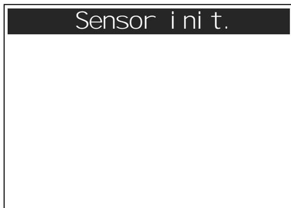
メニューの項目を選択すると、センサーの起動フェーズが開始されます。起動時間は約 30 秒で、常に新鮮な空気の中で実施する必要があります。
