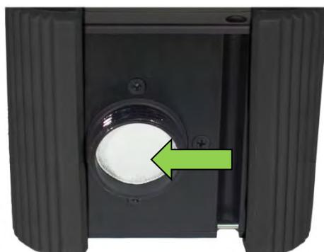
フィルターを挿入するときは、他のガスがフィルターを通過できないことを確認するために、フィルターが中央にあるのを確認してください。光沢があり構造化された面を内側に、無地の面を外側に向けます。
