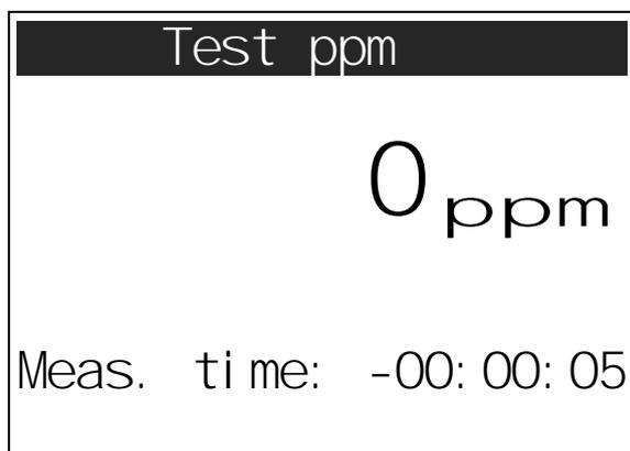
F2 (スタート) キーを押すと、-00:00:05 秒のカウントダウンで計測時間が始まります。この時点で、本機を正しい位置に配置し、テストガスを放出することができます。
