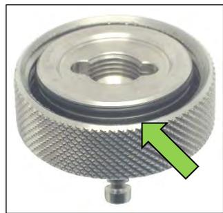
接続ヘッドの O リングに裂け目がないかチェックします。O リングの外側をワセリンでコーティングすると、ねじ込みが容易になります。
