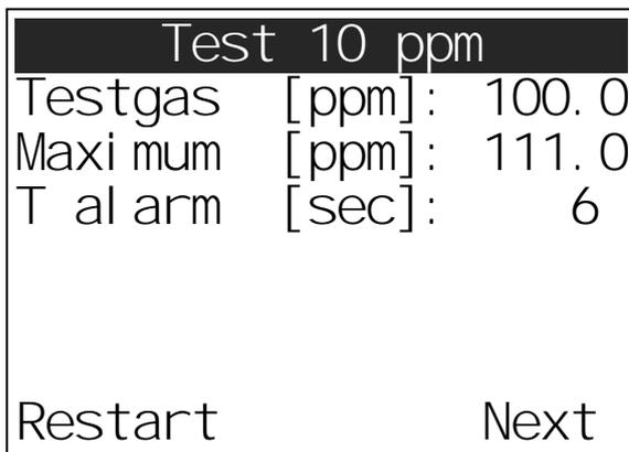
30秒が経過すると、100 ppm に到達するまでの秒数と、測定された最大値が自動的に画面に表示されます。
