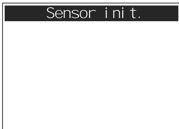
メニューの項目を選択すると、センサーの起動フェーズが開始されます。起動時間は約 30 秒で、常に新鮮な空気の中で実施する必要があります。センサーの起動フェーズは、画面の一番上の行に点滅する「Sensor init」によっても示されます。
