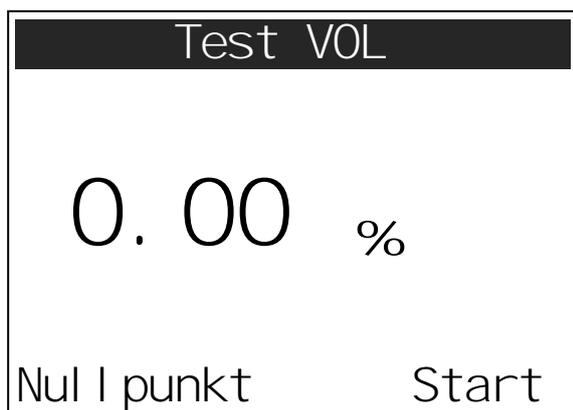
センサー起動フェーズの後、F1 キー (Zero) を使用してゼロ点をリセットできます。F2 キー (Start) が押され、テストガスが解放されると、測定時間が開始されます。
