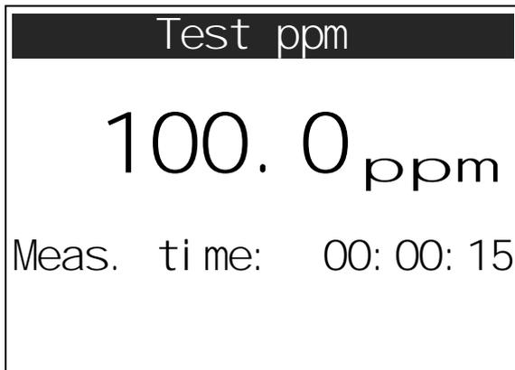
HUNTER H2 は測定値を ppm で表示します。そうすることで、デバイスは 100ppm に達するまでの時間を測定します。表示の最大値も記録されます。
