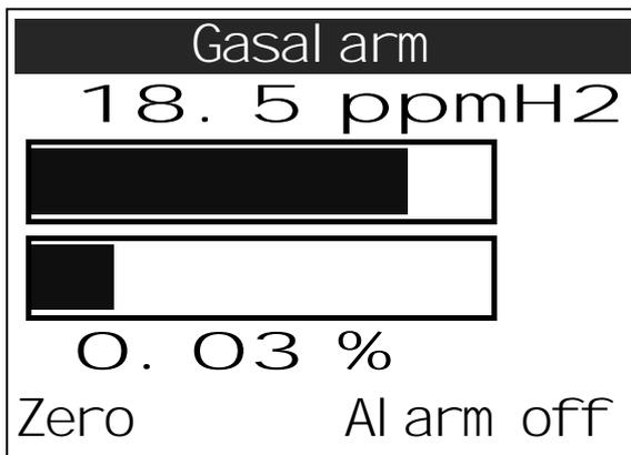
ガス濃度がアラームしきい値(設定メニューの「AlarmSC ppm」項目で変更可能)を超えると、音響および視覚アラームが起動します。画面に「Gas alarm」と表示され、画面のバックライトが点灯します。
