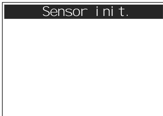
メニューの項目を選択すると、センサーの起動フェーズが開始されます。起動時間は約 25 秒で、常に新鮮な空気の中で実施する必要があります。センサーの起動フェーズは、画面の一番上の行に点滅する「Sensor init」によっても示されます。
