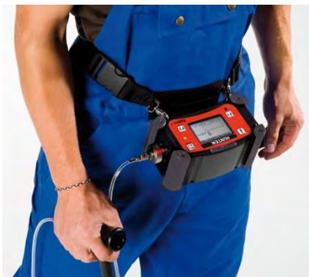
HUNTER H<sub>2</sub> の、特別なキャリアシステムによって、作業者の視野内に入るよう体の前で固定することで視界を広げて、探索中の安全確保と機器の揺れを防ぎます。
