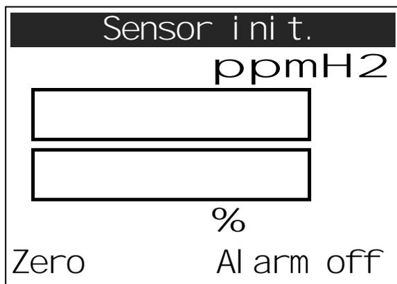
メニューの項目を選択すると、センサーの起動フェーズが開始されます。起動時間は約 25 秒で、常に新鮮な空気の中で実施する必要があります。センサーの起動フェーズは、画面の一番上の行に点滅する「Sensor init」によっても示されます。この間、測定値は測定されません。
