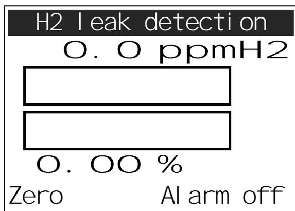
ディスプレイに 2 つのバーが表示されます。上部のバーは、水素センサーの信号を ppm H<sub>2</sub> で表します。センサーは水素に非常に敏感に反応し、0.1 ppm H<sub>2</sub> の分解能を備えています。この表示は、漏れを特定するために水素のごくわずかな痕跡を検出するのに役立ちます。下の棒グラフは熱伝導率センサーの信号を表し、濃度表示の分解能は 0.01% (100 ppm) です。熱伝導率センサーは、吸い上げられるガスサンプルと周囲空気との間の熱伝導率の差を示します。水素は非常に軽いガスであり、正の測定値で示されます。
