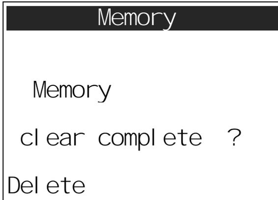
メニュー項目の「メモリのクリア (clear memory)」を選択すると、メモリ全体を消去できます。F1 キー (削除) を押すと、データストレージ全体が完全に消去され、すべての測定値が消去されます。記録を個別に削除することはできません。
