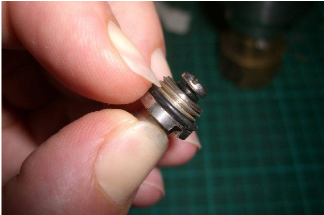
図30 取り外されたブリード弁
